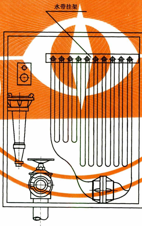
图 1 挂置式消火栓箱
