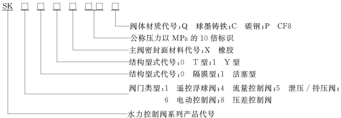
4.2.2 分体先导式减压稳压阀的型号编制方法应符合 CJ/T 256 的规定。
